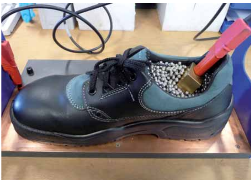
Prüfung des elektrischen Durchgangswiderstandes bei Sicherheitsschuhen.
