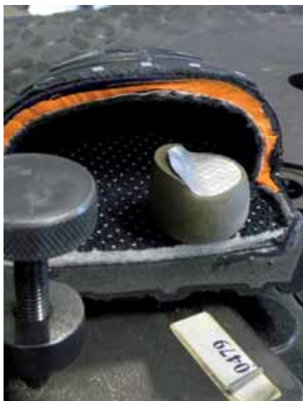
Zehenschutzkappen und Prüfkörper nach der Druckprüfung
