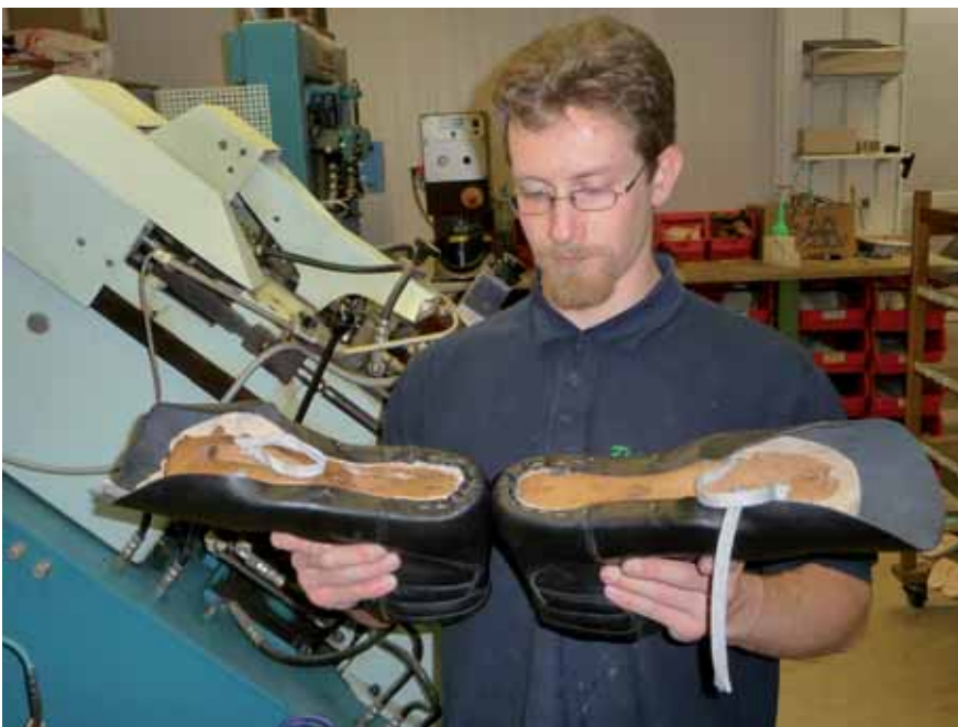
Die Herstellung orthopädischer Sicherheitsschuhe erfordert hohe Qualitätsstandards. Hier prüft der Orthopädeschuhmacher den korrekten Sitz des Schaftes auf dem Leisten.
